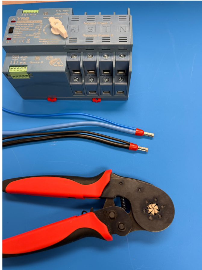
Bild 5 – Gemeinsame Verpressung von Anschlussleiter und Überwachungsbrücke
