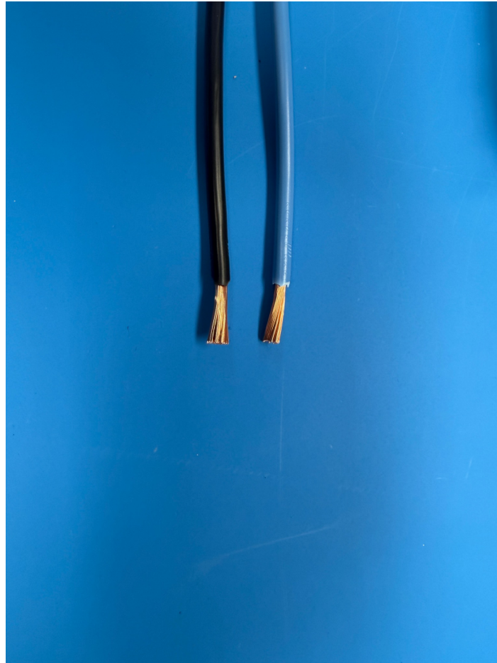
Bild 4 – Abgesetzte Anschlussleiter, exemplarisch 10 mm 2
